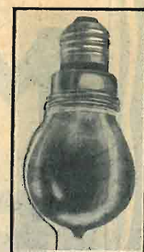
Fig. 5. — Il più recente tipo di raddrizzatore Tungar destinato alla carica di batteria da radio.
